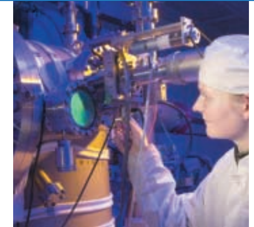
Abb.1: Wachstum von Quantenpunkten in der Molekularstrahlepitaxie.
