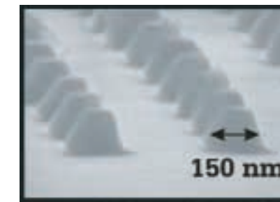
Abb.2 Elektronenmikroskopische Aufnahme nanostrukturierter Ferromagnete auf magnetischen Halbleiterschichten.
