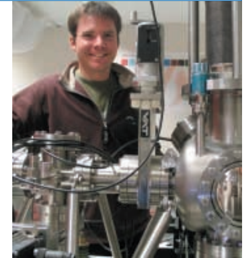
Abb.1: Konfokales/Nahfeldoptisches Mikroskop für den Einsatz im Ultrahochvakuum bei Temperaturen bis 8 Kelvin. Das Mikroskop entstand in Zusammenarbeit mit der Firma OMICRON Nanotechnology, Taunusstein, Deutschland.
