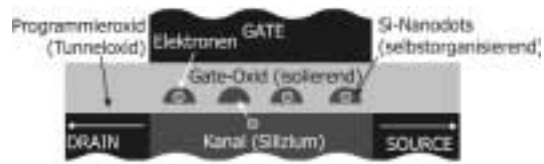
Abb.1a: Querschnitt durch eine Nanodot-Speicherzelle.
