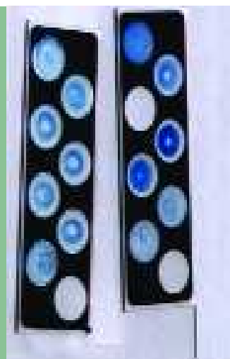
Abb.1: EPS-Test: Verfärbungen zeigen an, dass die Probe von Pilzen befallen ist.
