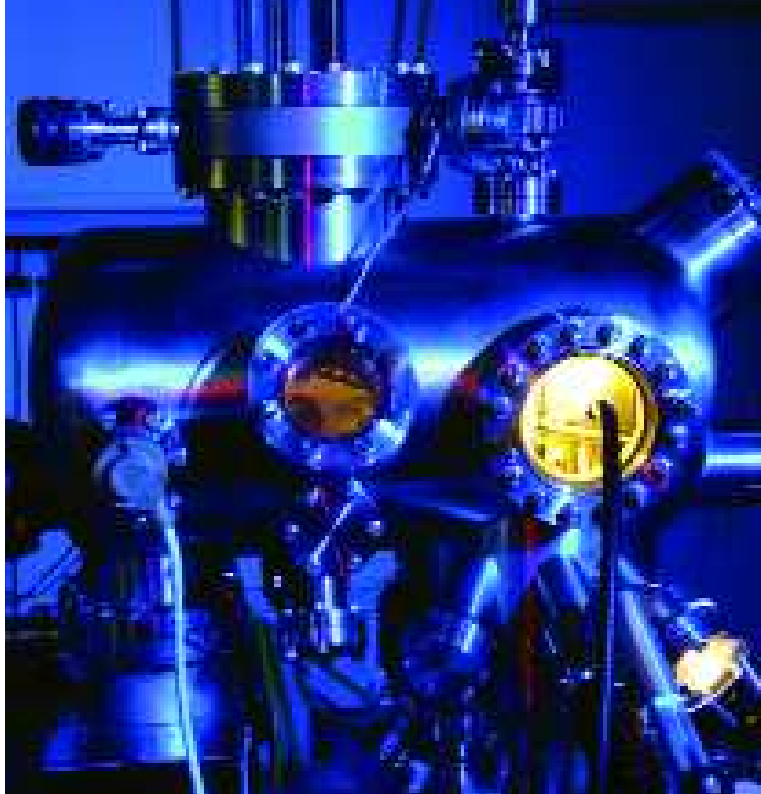
Erst die Fortschritte in der Analytik von nanometergroßen Strukturen ermöglichen die rasante Entwicklung von nanotechnologischen Innovationen. Das Tieftemperatur-Ultrahochvakuum-Rasterkraftmikroskop (Abb.) erlaubt die Untersuchung von Nanostrukturen unter welt-räumlichen Reinstbedingungen.
